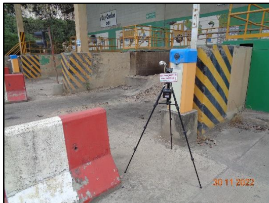
ภาพที่ 3.71 การตรวจวัดฝุ่นในสถานที่ทำงาน บริเวณระหว่าง Clay/Shale Crusher
