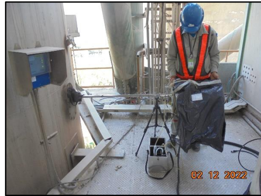
ภาพที่ 3.28 การตรวจวัด TOCจากปล่องหม้อเผา
