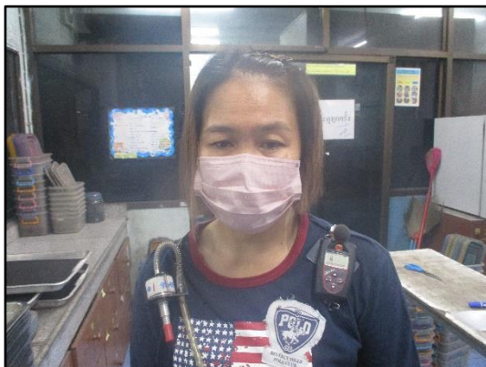
ภาพที่ 3.126 การตรวจวัดระดับเสียงที่พนักงาน สัมผัสประจำห้องเตรียมตัวอย่าง (ได้สายพาน)
