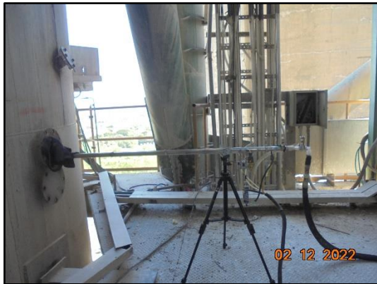
ภาพที่ 3.15 การตรวจวัด TSP, โลหะหนัก จากปล่องหม้อเผา
