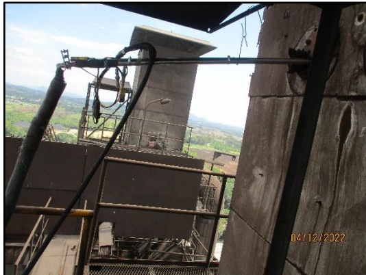
ภาพที่ 3.23 การตรวจวัด TSP จากปล่องหม้ออบคลinker 2
