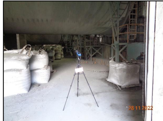
ภาพที่ 3.105 การตรวจวัดระดับเสียงบริเวณ เครื่องจักรบริเวณ Cement Mill 1
