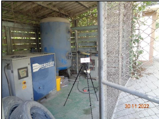
ภาพที่ 3.104 การตรวจวัดระดับเสียงบริเวณ เครื่องจักรบริเวณห้อง Compressor
