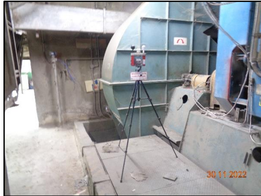
ภาพที่ 3.150 การตรวจวัดความร้อนในสถานที่ ทำงานบริเวณข้างพัดลม 920 B11M
