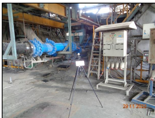
ภาพที่ 3.73 การตรวจวัดฝุ่นในสถานที่ทำงาน บริเวณ Cooler และ Kiln
