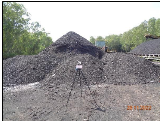
ภาพที่ 3.75 การตรวจวัดฝุ่นในสถานที่ทำงาน บริเวณกอง Coal
