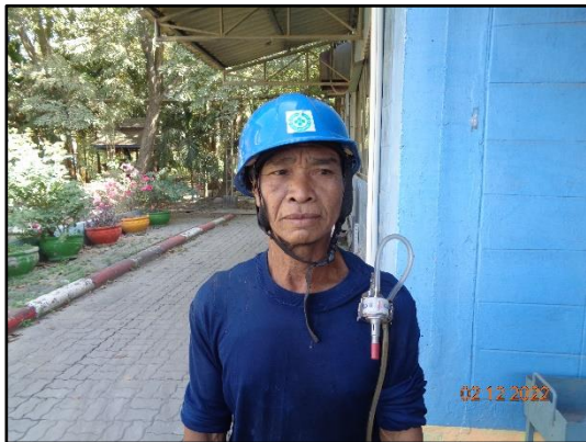
ภาพที่ 3.85 การตรวจวัดฝุ่นที่ติดตัวพนักงาน พนักงานประจำ Crusher ร.ข.
