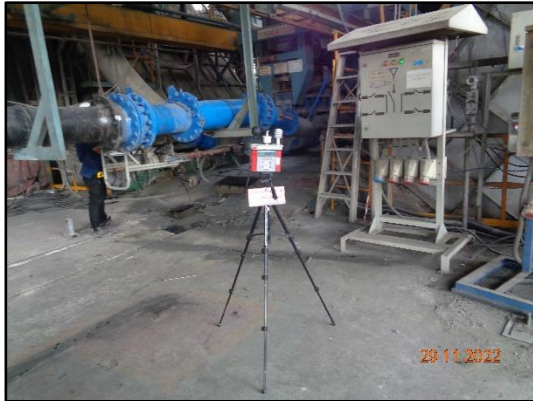
ภาพที่ 3.149 การตรวจวัดความร้อนในสถานที่ ทำงานบริเวณหน้า Main Burner
