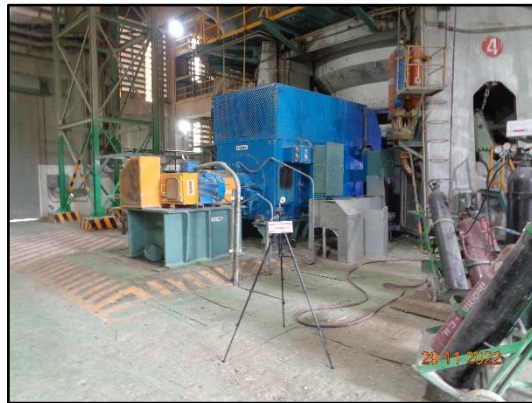
ภาพที่ 3.77 การตรวจวัดฝุ่นในสถานที่ทำงาน บริเวณหม้อบดวัตถุดิบ 1
