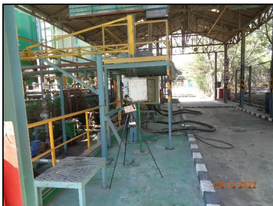
ภาพที่ 3.114 การตรวจวัดระดับเสียงบริเวณเครื่องจักร บริเวณปั๊มสูบลำของเสียที่เป็นของเหลว
