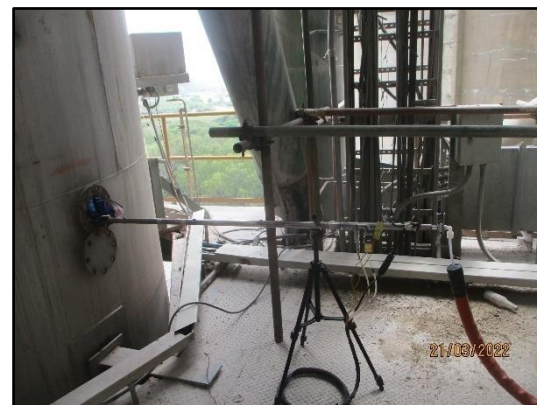
ภาพที่ 3.18 การตรวจวัดไดออกซิน จากปล่องหม้อเผา
