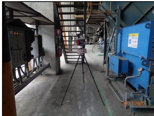
ภาพที่ 3.152 การตรวจวัดความร้อนในสถานที่ ทำงานบริเวณข้างพัดลม 920 B16M
