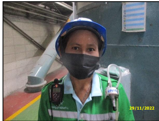
ภาพที่ 3.91 การตรวจวัดฝุ่นที่ติดตัวพนักงานประจำ Packer 6-10
