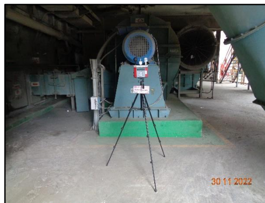
ภาพที่ 3.153 การตรวจวัดความร้อนในสถานที่ทำงานบริเวณข้างพัดลม 920 B3M
