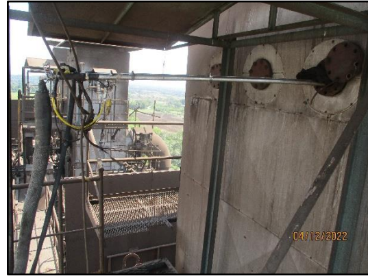
ภาพที่ 3.22 การตรวจวัด TSP จากปล่องหม้ออบคลinker 1
