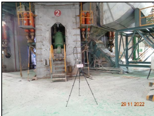
ภาพที่ 3.78 การตรวจวัดฝุ่นในสถานที่ทำงาน บริเวณหม้อบดวัตถุดิบ 2
